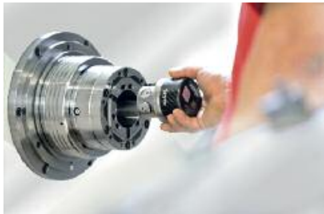
TESTit, il nuovo dispositivo di misurazione della forza di serraggio di Hainbuch
