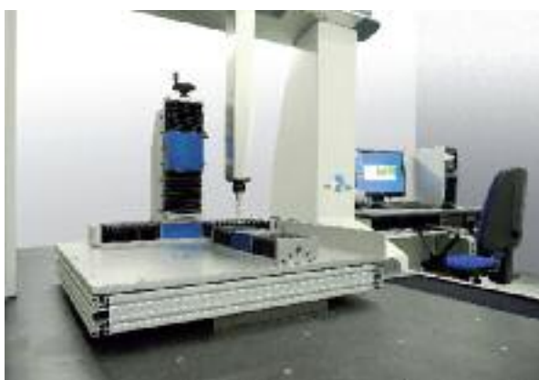
Sala metrologica, controllo geometrico finale su un sistema di tavole a 3 assi realizzato da Meccanica Besnatese
