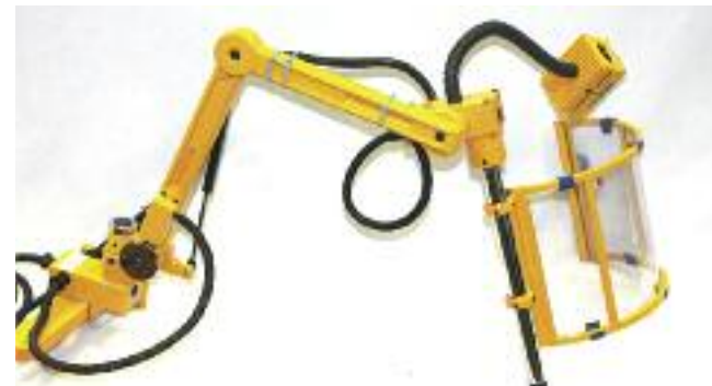
Protezione per fresatrice composta da doppio braccio snodato in alluminio pressofuso, bilanciato tramite molla a gas, cupola in acciaio con schermo in policarbonato. Braccio completo di triplo micro che regola ogni apertura/movimento (apertura completa, solo cupola e alzata verticale). Grado di protezione dei Micro IP67, apertura forzata, doppio contatto NC e un contatto NO. Protezione completa di Lampada a Led 10/30V 20W AC/DC con interruttore ON/OFF
