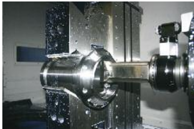
Testa angolare Evolution Line in lavorazione montata su di un centro orizzontale
